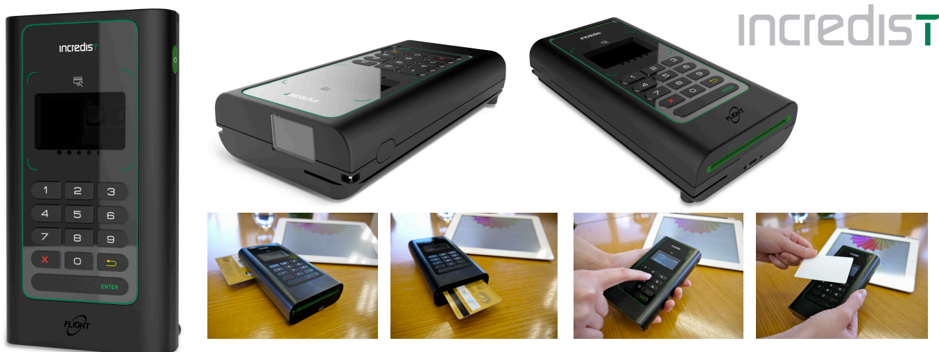
（左から）クレジットカード（磁気）読取、クレジットカード（IC 付きカード）読取、暗証番号入力、電子マネー読取
